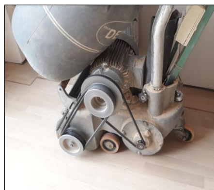
Fig. 8: Proceso de cepillado de un parquet
