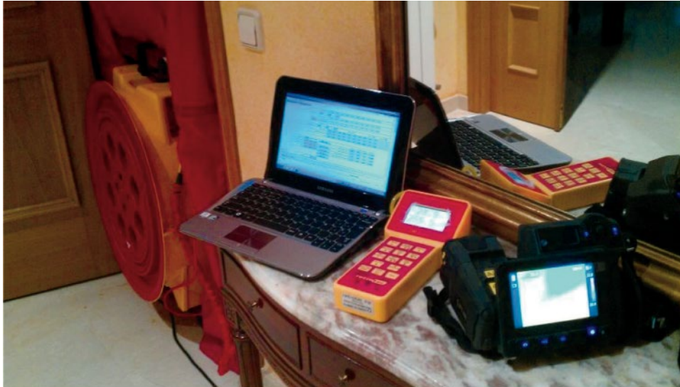
Imagen 7.3: Imagen interior emplazamiento equipos ensayo (fuente: Termagraf).
