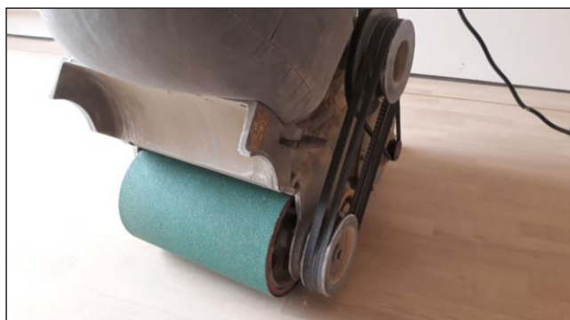
Fig. 8: Proceso de desbastado y lijado de un pavimento. Utilización de una lijadora eléctrica profesional.
