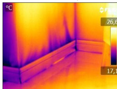
Fig. 3: Termografía del encuentro de una tabiquería de placa de yeso laminado con un solado. Se aprecian infiltraciones de aire.
