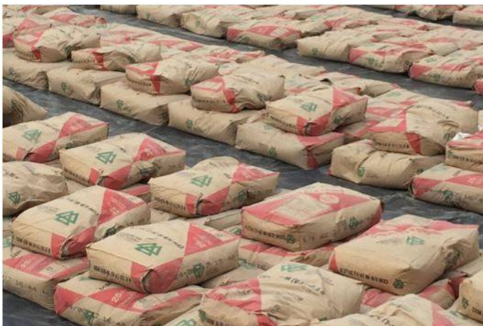
Fig. 3: Acopio de cemento en sacos
