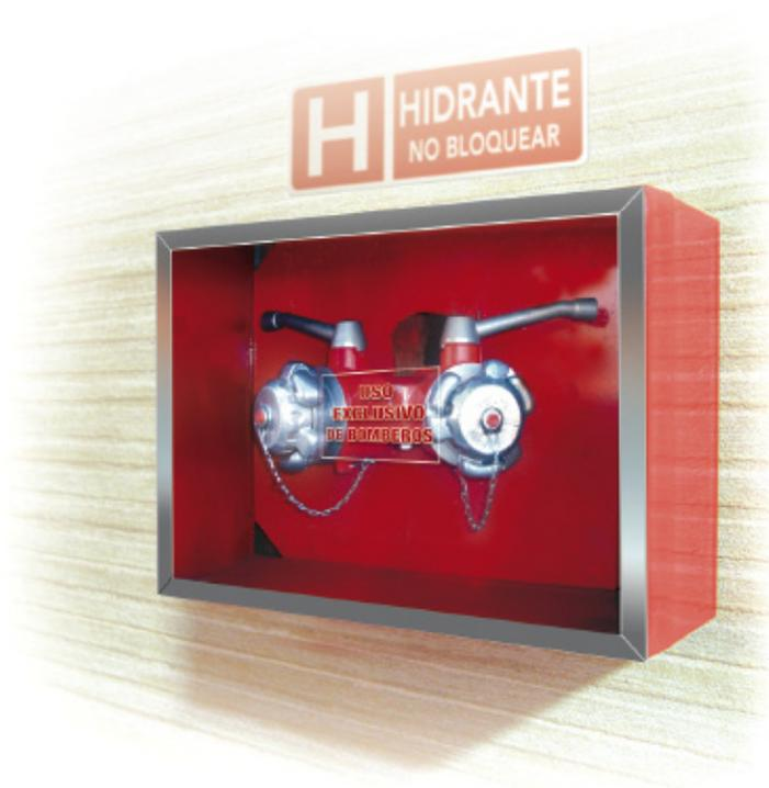
La toma estará dotada de válvula anti-retorno, conexión siamesa, con llaves incorporadas y racores de 70 mm, con tapa y llave de purga de 25 mm, centro de las bocas a 0,90 m sobre el nivel del suelo, al igual en las tomas de planta; con sistema de drenaje después de la válvula para el posterior vaciado final de la instalación.
