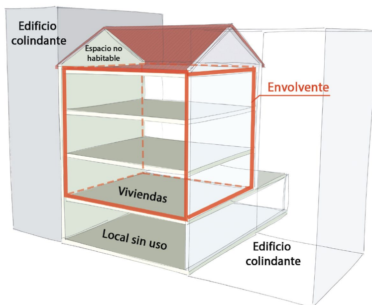
Figura 28. Envolvente térmica del edificio entre medianeras.
