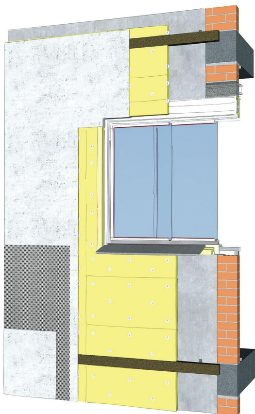
Figura 40. Detalle de una solución con SATE. Fuente: (González Juan, 2024)
