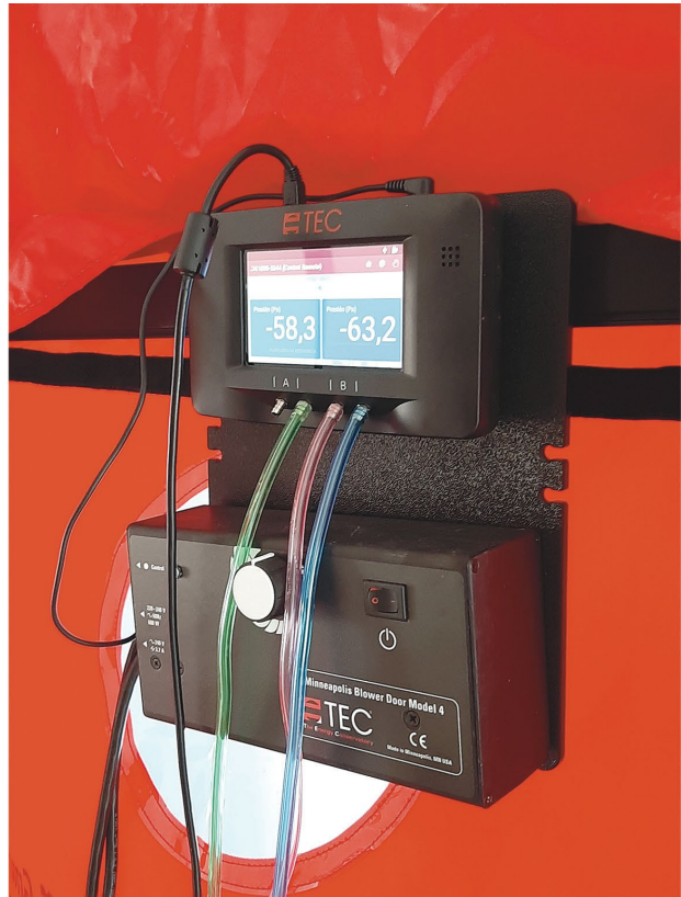
Figura 69. Medición de la permeabilidad al aire del edificio mediante el ensayo "Blower Door".
