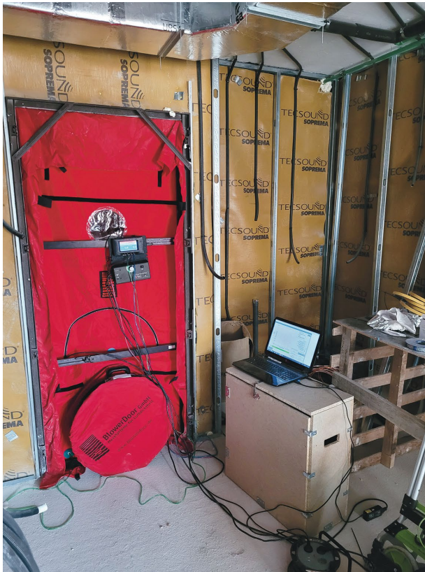
Figura 69. Medición de la permeabilidad al aire del edificio mediante el ensayo "Blower Door".
