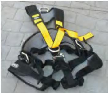
Imagen 34. Arnés de asiento que incorpora un arnés anticaídas y cinturón de sujeción.
