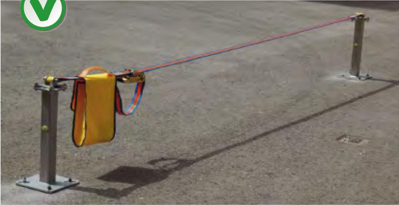
*Imagen 71. Combinación de dispositivo de anclaje B (línea textil horizontal) sobre dispositivos tipo A (mástiles con chapa) con elementos de fijación anclados a la estructura (tornillos). Los tornillos deberían ser de métrica 12 como mínimo y de marca reconocida. Al tratarse de un anclaje (tornillos) no cubierto por la EN 795 debería realizarse una prueba de la resistencia estática y dinámica.*
