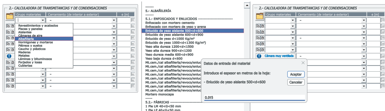
Imagen 121. Proceso de introducción de capas del cerramiento de interior a exterior.
