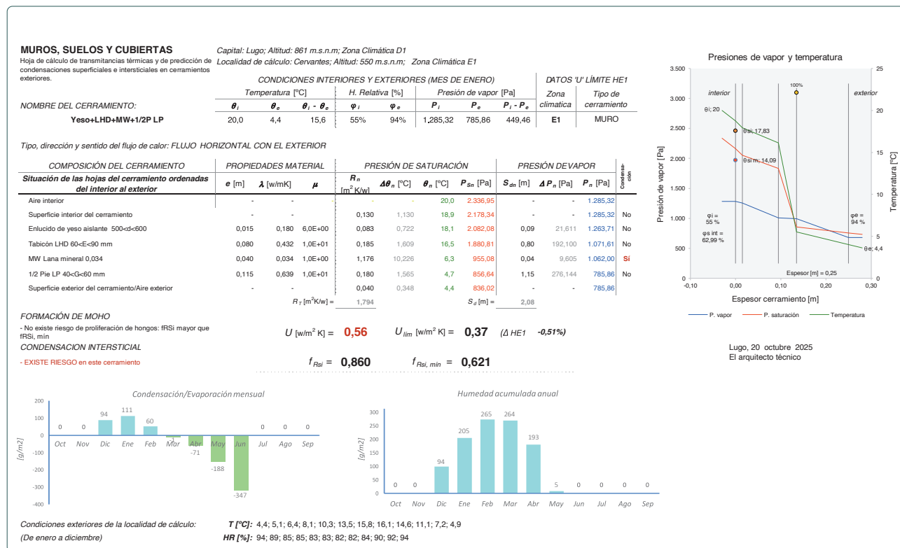
Imagen 125. Informe completo del cálculo del cerramiento.
