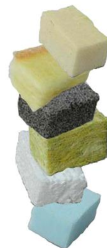
Fig. 6: Distintas probetas cúbicas de varios tipos de aislamientos térmicos utilizados en edificación
