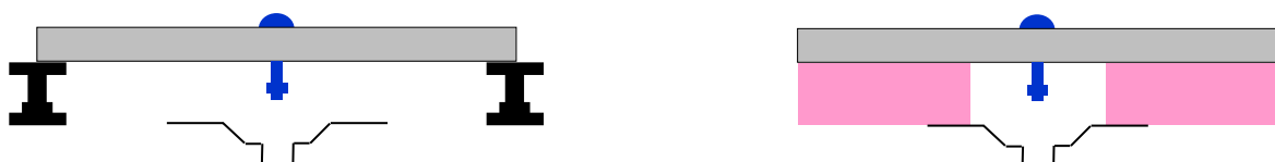
Fig. 3: Esquema de baldosas con un pasador incorporado para permitir su elevación, inspección y posterior mantenimiento (Dibujo izquierdo: para sistema sobre plots ; Dibujo derecho: sistema con aislante XPS integrado)
