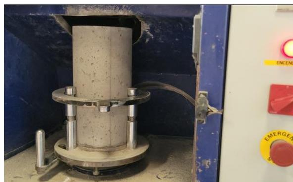
Fig. 2: Proceso de pulido de probeta de hormigón
