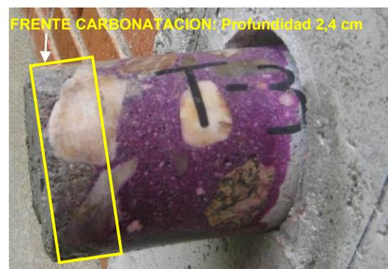
Fig.7. Carbonatación del hormigón. Test a la fenolftaleína
