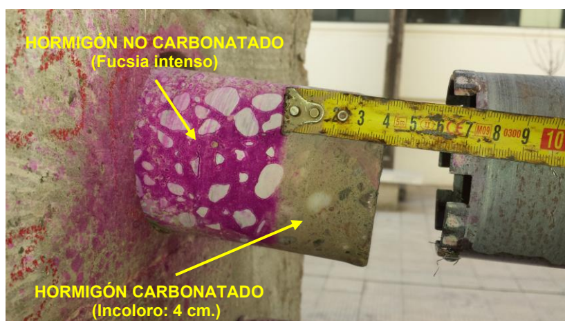
Fig. 9. Determinación de la profundidad de carbonatación en testigo de hormigón de un pilar. “Test Fenolftaleína”
