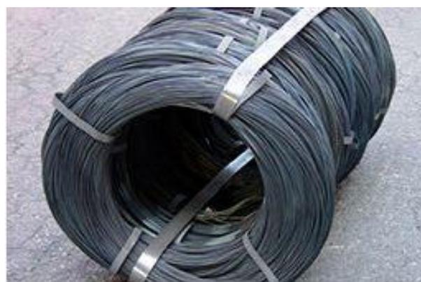
Fig. 2: Barras de acero en rollo
