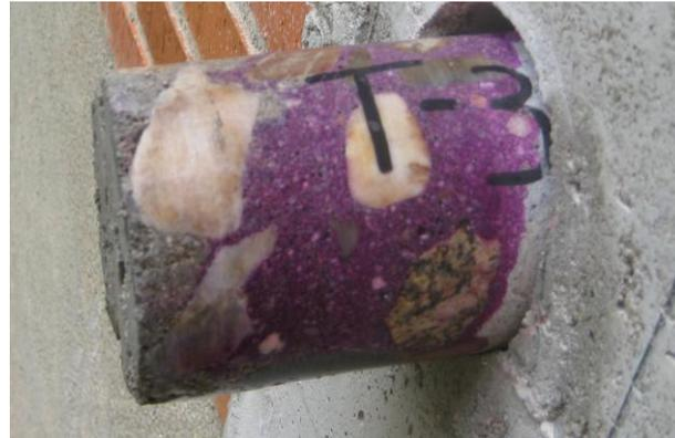
Fig. 2. Carbonatación del hormigón
