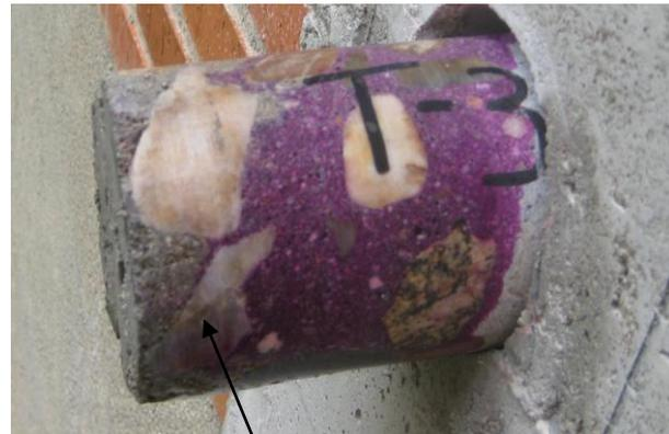
Fig. 2: Carbonatación del hormigón
