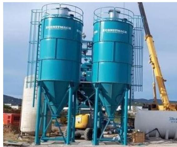
Fig. 4: Silos almacenamiento de cemento a granel
