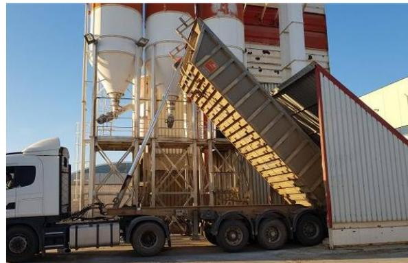
Fig. 1: Suministro de arena en planta de hormigones
