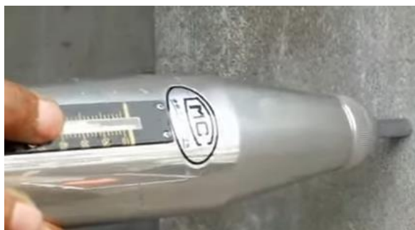
Fig. 1: Índice de rebote. Esclerómetro Schmidt
