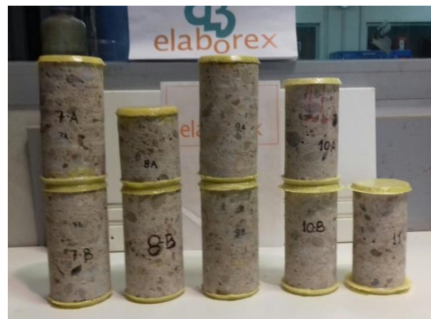
Fig. 5: Probetas testigos de hormigón
