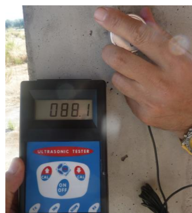
Fig. 10: Velocidad de propagación de ultrasonidos
