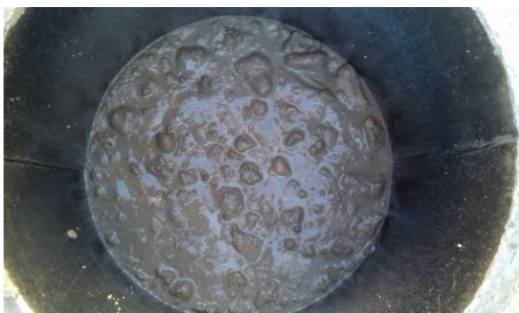
Fig. 4: Compactado de probetas cilíndricas
