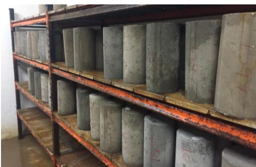
Fig. 6: Curado de probetas cilíndricas en cámara de húmedos
