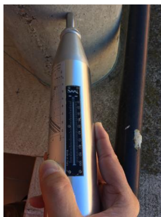
Fig. 9: Índice de rebote. Esclerómetro
