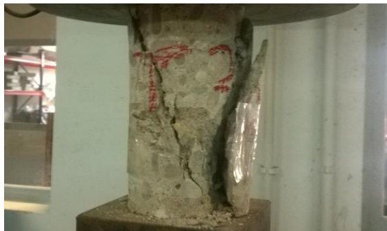
Fig. 2: Rotura a compresión probeta hormigón
