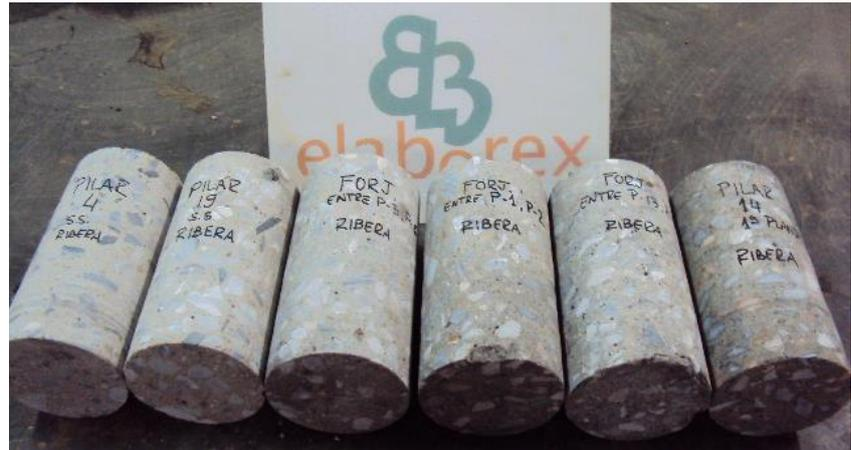
Fig. 12: Testigos de hormigón de 100 mm de diámetro
