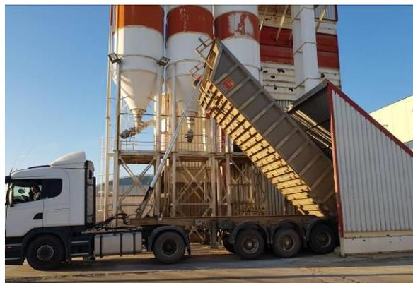
Fig. 1: Suministro de arena en planta de hormigones
