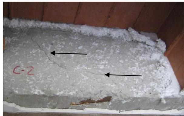
Fig. 19. Fisuración en viga por esfuerzo cortante
