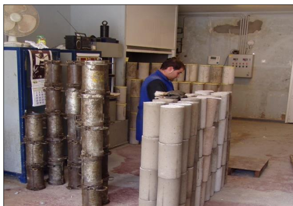
Fig. 1: Llegada y desmoldeo de probetas de hormigón en un LCC
