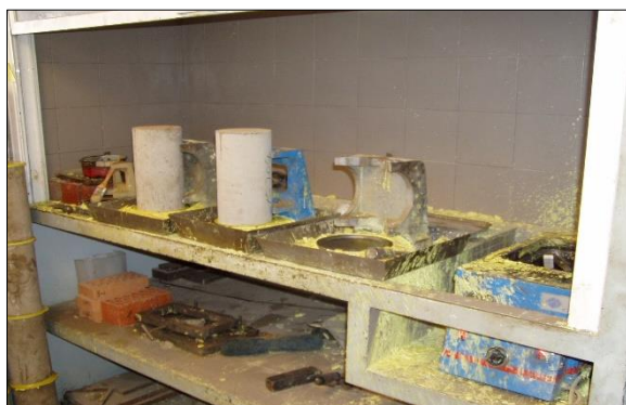
Fig. 2: Proceso de refrentado de probetas con mortero de azufre
