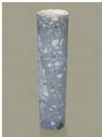
Testigo de muro
