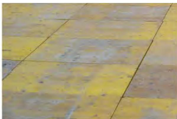
Tablero contrachapado fenólico para **encofrado**
