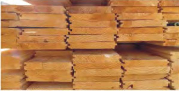
Ensamblados machihembrados tipo “de horquilla”
