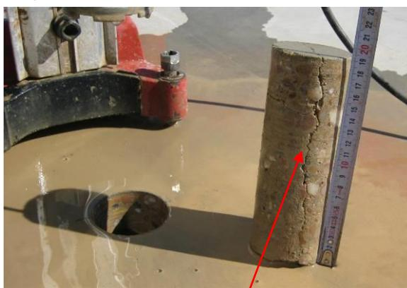
Fig. 6. Fisura en solera Testigo de hormigón
