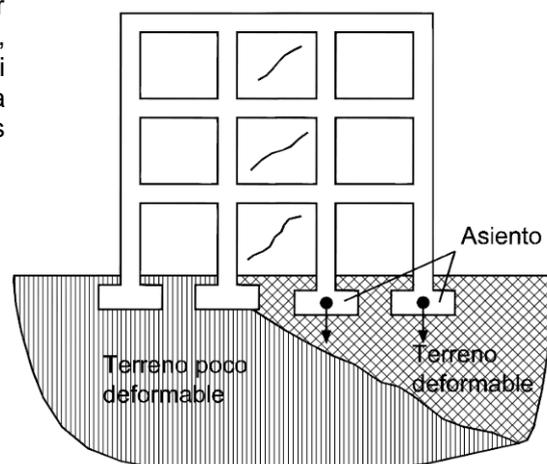
Figura 3: Asientos diferenciales. Fisuras
