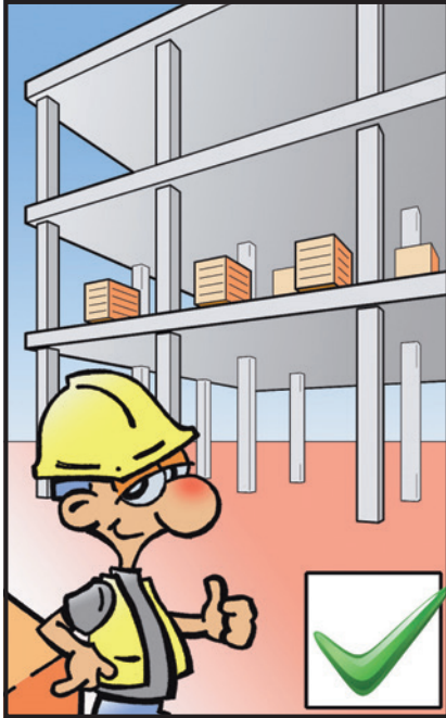
-Dibujo 2- Forma de hacer el acopio de los palés sobre los forjados: distribuidos por planta (correcto) o concentrados en un punto (incorrecto).
