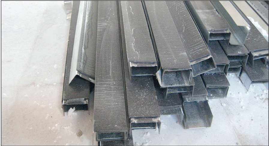
-Imagen B- Perfiles metálicos tipo canal con banda elástica adherida al trasdós del alma.
