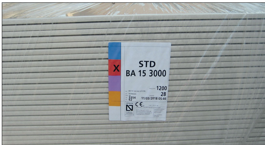
-Imagen C: Acopio de placas de yeso laminado tipo estándar, de borde afinado, de 15mm de espesor, 3m de alto y 120cm de ancho.
