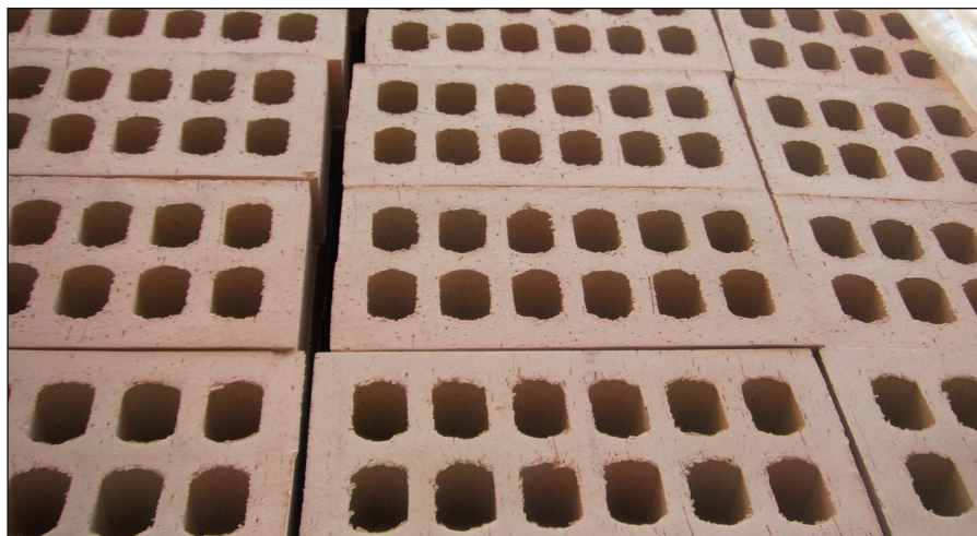
-Imagen A- Vista superior de un palé de ladrillos cara vista perforado de orificios cuadrangulares.
