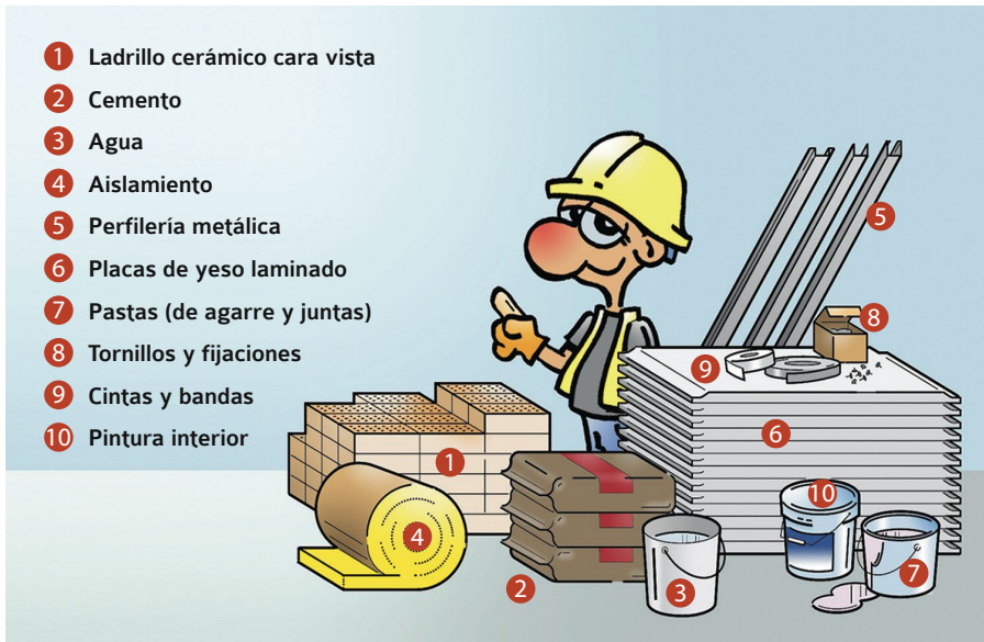
-Dibujo 1- Principales materiales para la realización de esta tipología de fachada de ladrillo.
