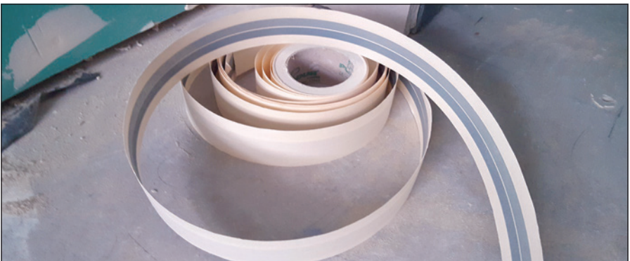
-Imagen F- La cinta de guardavivos tiene dos tiras de refuerzo mínimamente separadas entre sí para poder doblar entre ellas y reforzar así la arista del encuentro en las placas.
