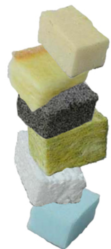
Fig. 6: Distintas probetas cúbicas de varios tipos de aislamientos térmicos utilizados en edificación
