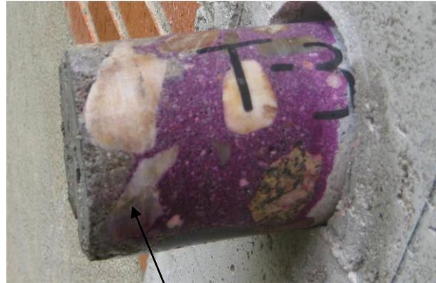
Fig. 2: Carbonatación del hormigón
